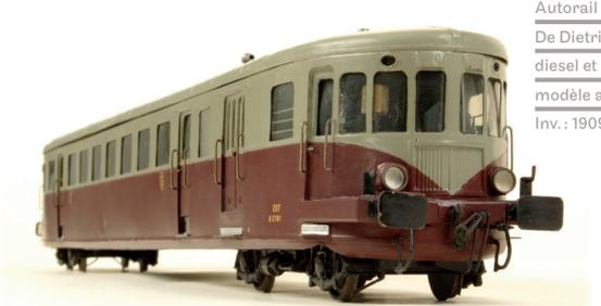
Autorail type De Dietrich à 2 moteurs diesel et à bogies, modèle au 1/43, 1949
